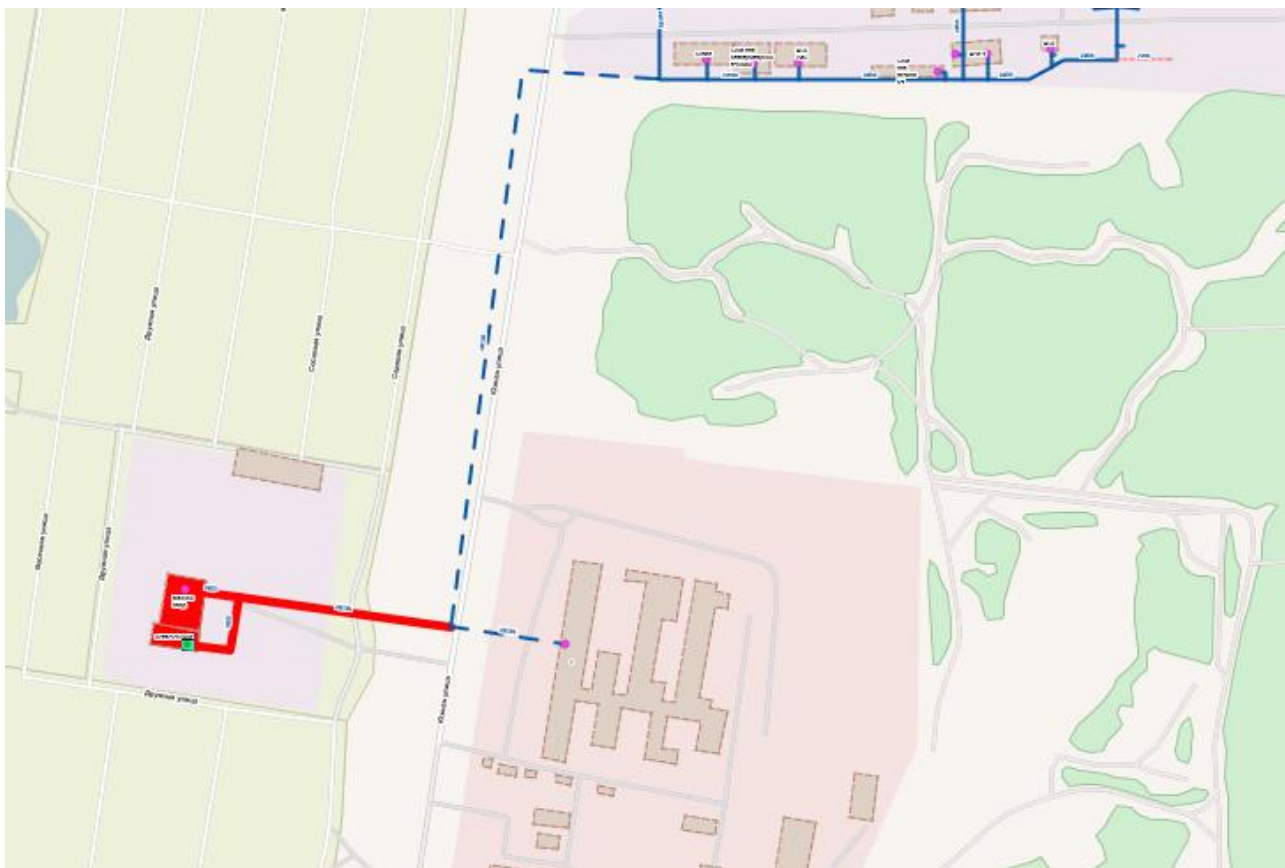
Рисунок 35. Визуализация отключения запорной арматуры Уз.79-ТК-3 (котельная КОС)
