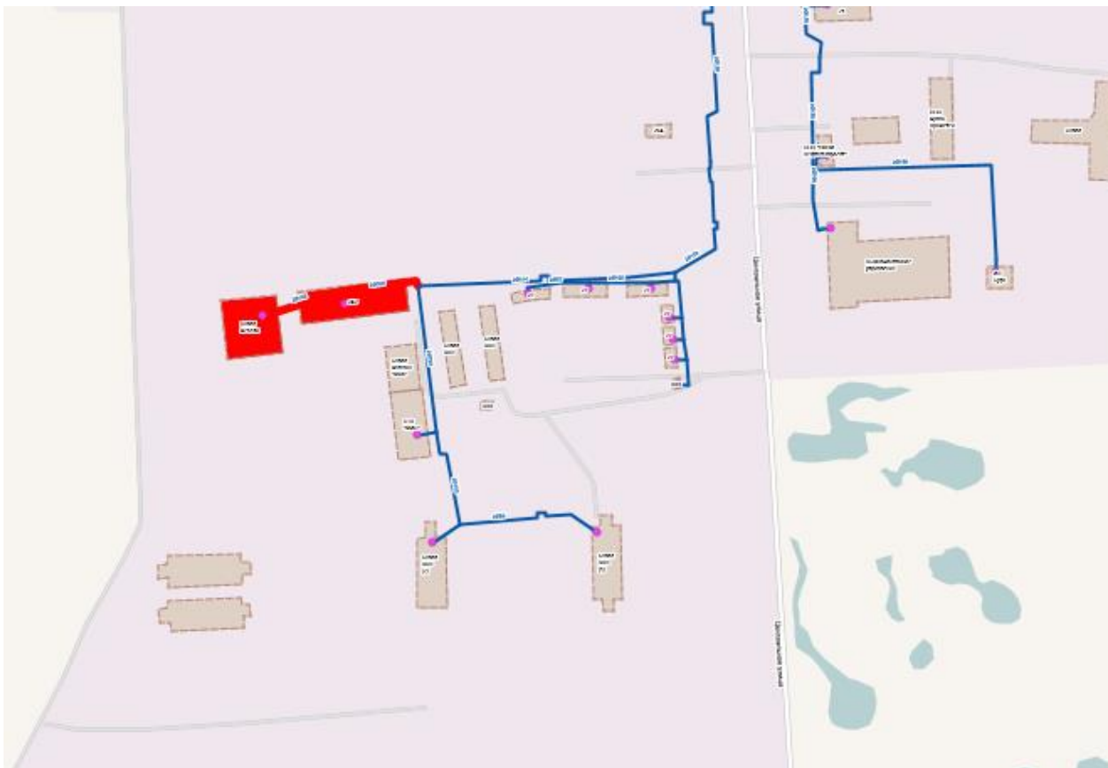
Рисунок 38. Визуализация отключения запорной арматуры 17ТУ-21-Уз.441 (котельная СУ-78)
