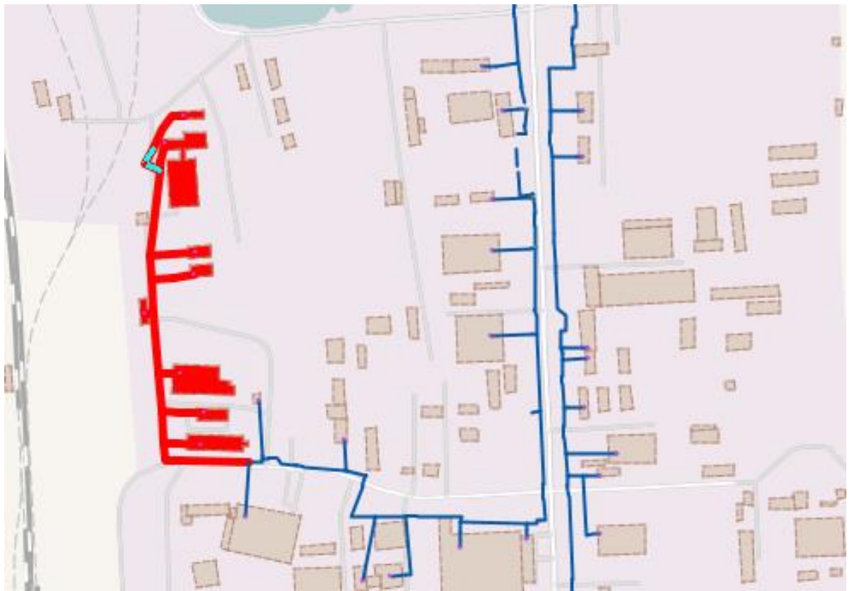
Рисунок 29. Визуализация отключения запорной арматуры Уз.41-ЗУ 21 (котельная ВКГМ)
