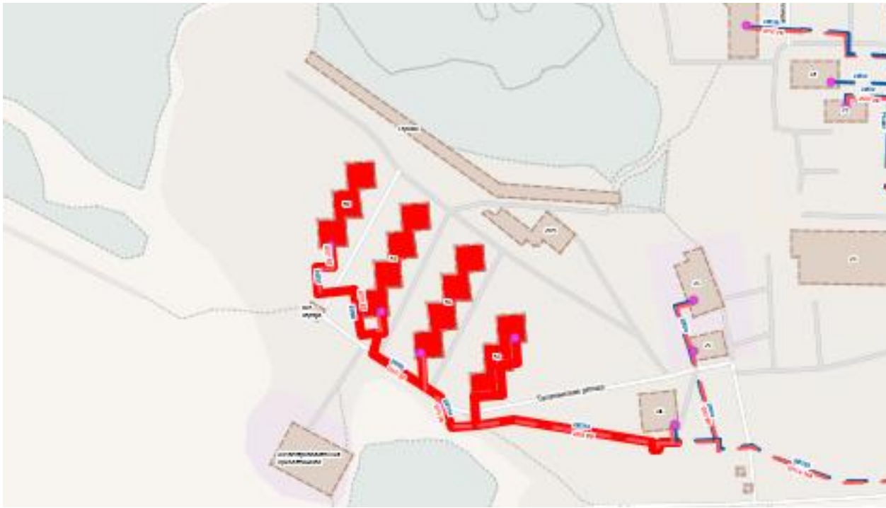
Рисунок 37. Визуализация отключения запорной арматуры Уз.564-19УТ-70 (Котельная ПМК-177)
