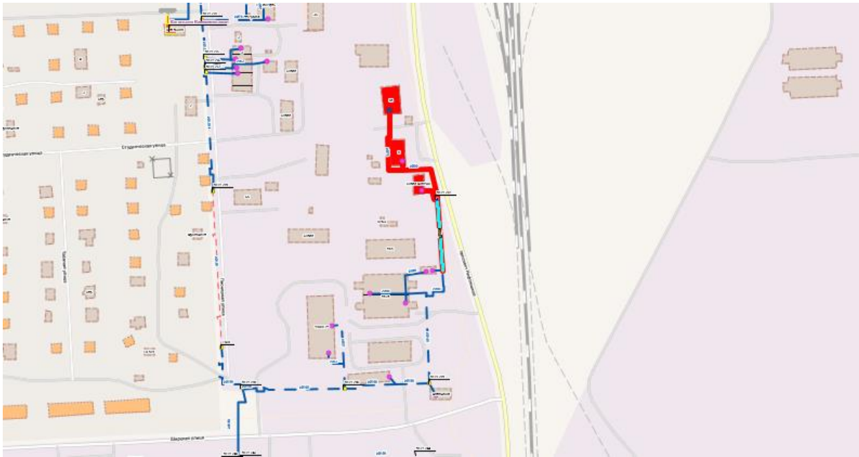
Рисунок 33. Визуализация отключения запорной арматуры ЗУ Уз.103-«Регион груз сервис» (котельная по ул. Комсомольская)
