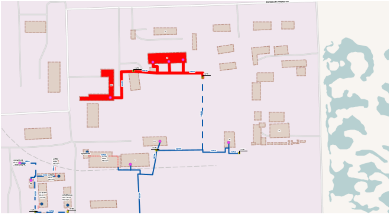
Рисунок 39. Визуализация отключения запорной арматуры ТК-18-Уз.151 (котельная УПТК)
